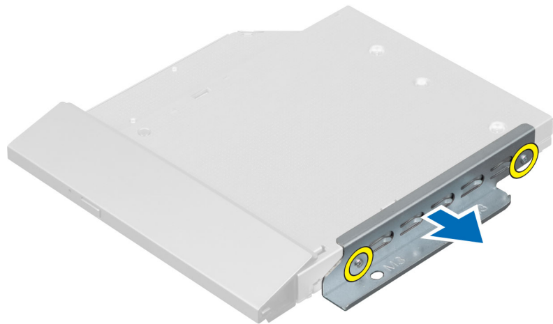
6. הסר את הברגים שמהדקים את תושבת הכונן האופטי לכונן האופטי. הסר את תושבת הכונן האופטי מהכונן האופטי.
